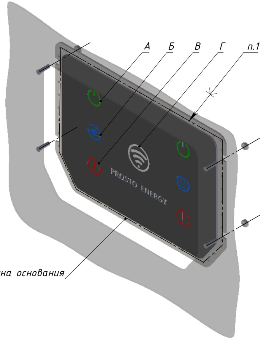
1. Перед монтажом Панели управления нанести на пластину основания клей-герметик Exfix MS2200 (или аналогичный заменитель) по траектории указанной штрих пунктирной линией.
